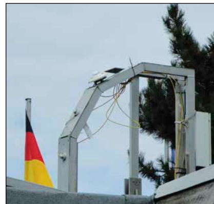
Bild 4: Messgeräte auf dem Anbau des Solarhauses für die Globalstrahlung auf die 30°, 60° und 90° Ebene (Südrichtung)
